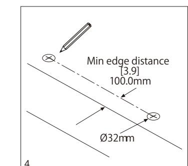
4. Twin Feet Fixingを固定する下穴2箇所の中心点に印を付け、ドリルで\*\*直径32mmの穴を開けます。
