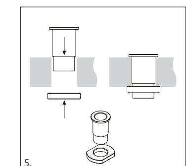
5. 付属のスリーブを差しこみ、裏側からねじ穴付きプレートに締め付けます。レンチを使用してしっかりと締め付けて下さい。
